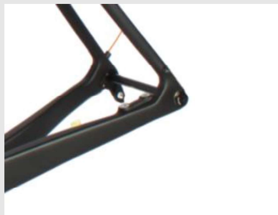
Scheibenbremse (Flat Mount) Bremsscheibendurchmesser 160mm oder 180mm
